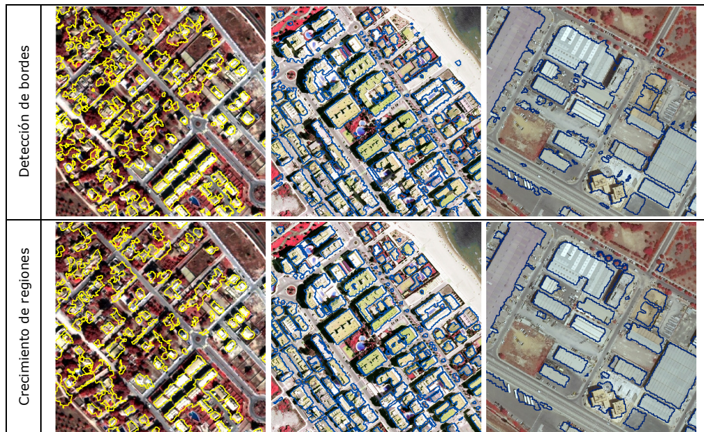
Figura 28. Detalles de la segmentación empleando ambos métodos sobre una zona periurbana en Moncada (izquierda), una zona urbana en Oliva (centro) y una zona periurbana en Sagunto (derecha).
