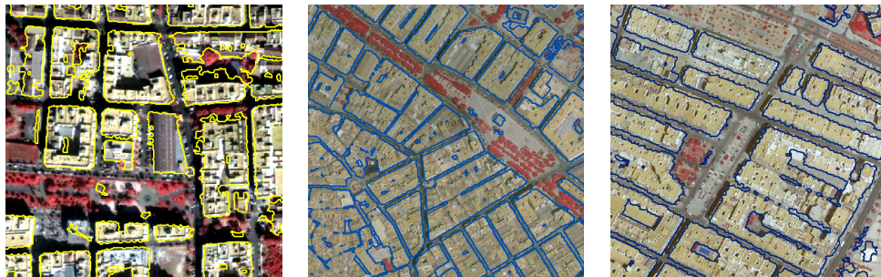
Figura 24. Ejemplos de la detección de edificaciones de tipología urbana en Moncada (izquierda), Oliva (centro) y Sagunto (derecha).
