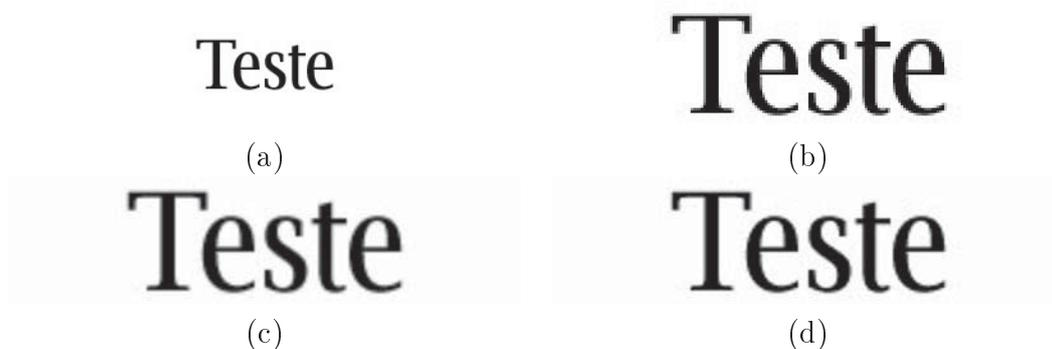
Figura 2.1: Exemplos de uso de diversas técnicas de interpolação: (a) original, (b) vizinho mais próximo, (c) bilinear e (d) bicúbica.
