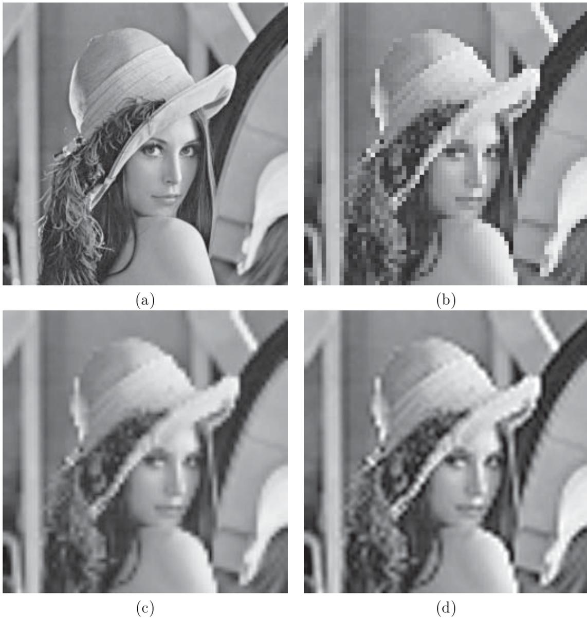
Figura 3.3: Efeitos dos métodos de interpolação utilizando um fator de redução e ampliação de 4. (a) Original, (b) Vizinho mais próximo, (c) Bilinear e (d) Bicúbico.
