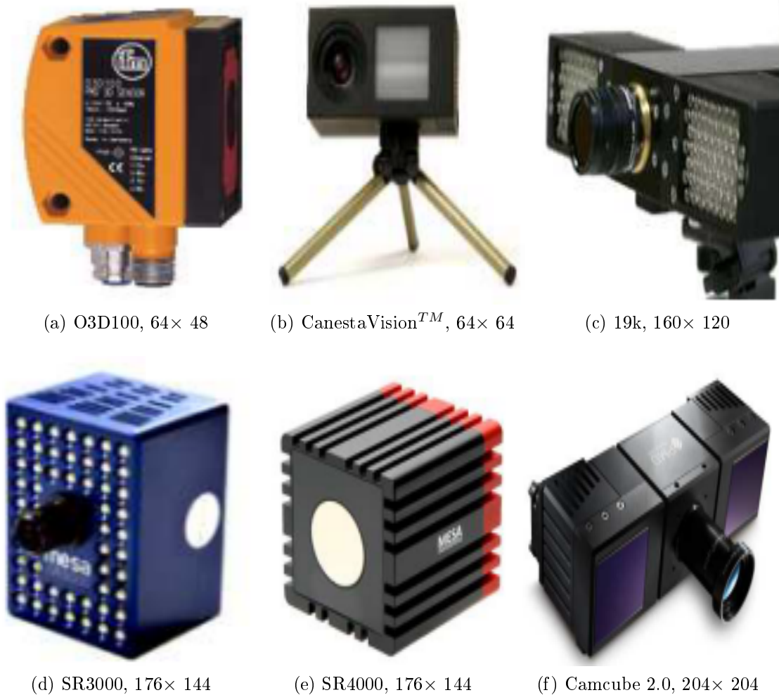
FIGURE 1.6 – Quelques exemples de caméras Temps-de-Vol basées sur la modulation de type "lock-in pixels". Leur résolution spatiale est faible : elle varie de 64× 48 à 204× 204 (actuellement la plus haute résolution disponible sur le marché).
